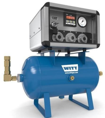
균일한 가스 혼합을 위해서는 개별 가스 입구 압력을 균일하게 유지하는 것 또한 매우 중요합니다. WITT 고성능 가스 혼합기는 내부에 돔 로드 레귤레이터(파일럿 레귤레이터)를 적용하여 입구 압력을 일정하게 유지합니다. WITT는 중대형 가스 혼합기의 경우, 개별 가스 입구압력모니터링(NXT+)을 통해 개별 가스가 일정한 압력으로 공급되는지 여부를 지속적으로 확인하며, 설정된 압력 범위를 벗어날 경우 알람 경보를 발생하여 균일한 가스 혼합을 가능하게 합니다. 또한 혼합기 일체형 가스 분석기 옵션을 통해 혼합가스 품질이 균일하게 유지되는지 확인할 수 있습니다.
