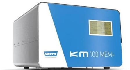
혼합 밸브로 가스 농도를 조절하면 오리피스와 피스톤 운동에 의해 가스 유량을 제어하여 원하는 농도의 혼합가스를 생성합니다. 고품질 자재로 정밀 생산된 개별 부품은 피스톤 - 오리피스 유량 공급으로 놀라운 고품질 가스 혼합 테크놀로지를 선보입니다. 전자식 혼합기는 원격 제어로 가스 혼합 시스템 네트워크를 구성할 수 있으며, 중앙에서 쉽고 편리하게 제어할 수 있습니다. 혼합기 내부의 돔 로드 레귤레이터(파일럿 레귤레이터)를 적용하여 입구 압력을 일정하게 유지하며, 산업 분야에 따라 혼합가스를 연속적으로 또는 간헐적으로 사용할 수 있습니다. (혼합가스를 간헐적으로 소비할 경우 혼합기 출구측 리시버 탱크 필요)
