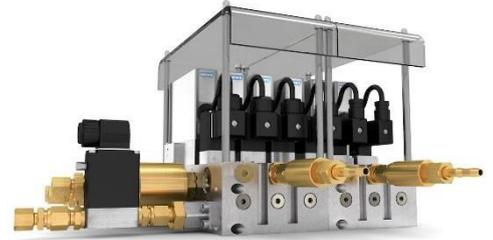
완전 전자식 제어 장치는 개별 가스의 질량 유량을 최적화하고 압력 변동이나 온도 영향 등의 외부 요인에 대한 보상을 통해 혼합가스 생산 공정 전체에 걸쳐서 매개 변수를 안정적으로 유지합니다. 따라서 추가적인 압력 제어 장치나 온도 측정이 필요하지 않습니다. 또한 개별 제품에 사용되는 혼합가스의 유속 매개 변수를 저장하여 불러올 수 있기 때문에 생산 품목을 변경할 때 소요 시간이 최소화됩니다.
