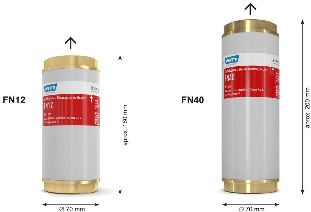
**WITT – Válvula anti-descomposición para una protección fiable contra descomposición de acetileno y retrocesos de llama de gases combustibles. Cada válvula anti-descomposición es testado al 100%.**
