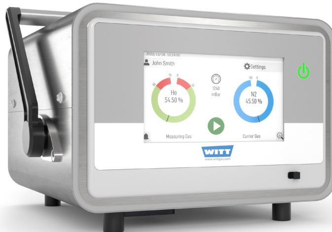
**Analizador de gas compacto y portátil para la medición de 16 diferentes mezclas de gas binarias. Modo de medición basado en la conductividad térmica. El equipo ideal para el análisis móvil y para el servicio técnico.**
