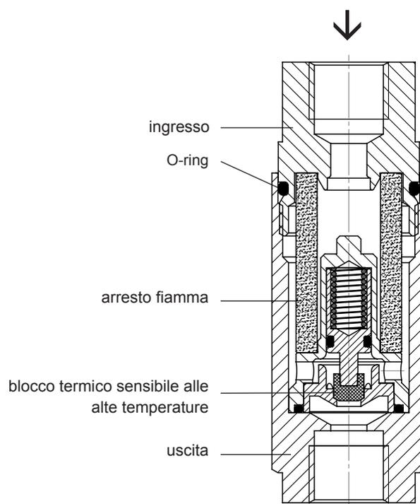
**Valvola anti ritorno di fiamma WITT F53N/HHO per una protezione affidabile contro il pericoloso ritorno di fiamma in applicazioni con miscele di Idrogeno e Ossigeno. Ogni valvola è testata al 100%.**
