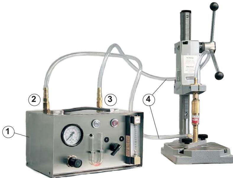
**Flammenrückschläge, Verunreinigungen oder mechanische Beanspruchungen können zu Leistungs- und Funktionsbeeinträchtigungen von Sicherheitseinrichtungen und Gasrücktrittsicherungen führen. Daher ist eine jährliche Funktionsüberprüfung von allen Sicherheitseinrichtungen unerlässlich gemäß: TRAC 207, Nr. 9.36 und BGR 500 / DGUV-R 500 Kap. 2.26 Punkt 3.27 sowie TRBS 1201 / TRBS 1203.**
