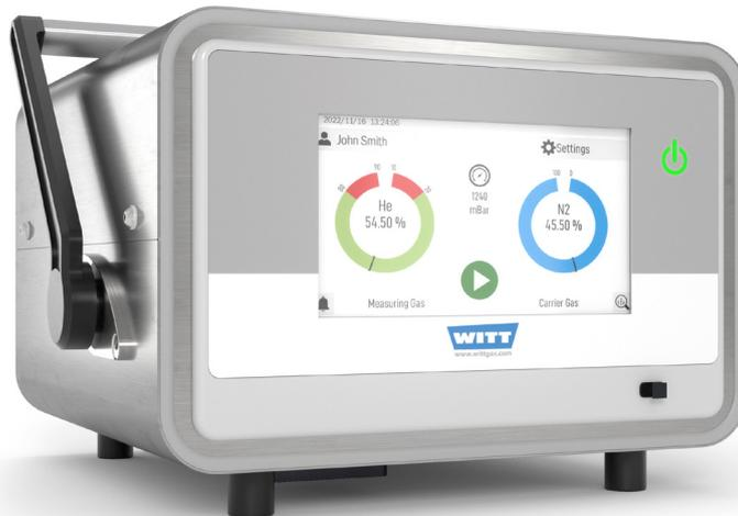
**Kompaktes, tragbares Gerät zur Messung von 16 verschiedenen binären Gasgemischen basierend auf dem Messprinzip der thermischen Leitfähigkeit. Das ideale Gerät für die mobile Analyse vor Ort und für Serviceeinsätze.**
