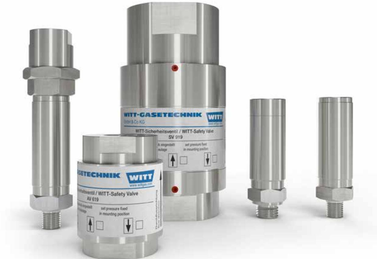
Le valvole di sicurezza per sovrappressione WITT consentono lo scarico delle sovrappressioni sia di linea sia dai contenitori di gas e da altre apparecchiature dell'impianto. Funzionano ad azione diretta a molla pre-caricata e permettono singole pressioni di apertura da 5 mbar a 45 bar. Per le sue dimensioni compatte e le svariate possibilità di installazione in qualsiasi posizione, consentono un utilizzo variabile per molte applicazioni.
